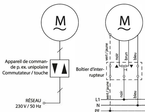
Commande d'un entraînement avec commutateur de volet roulant unipolaire.
