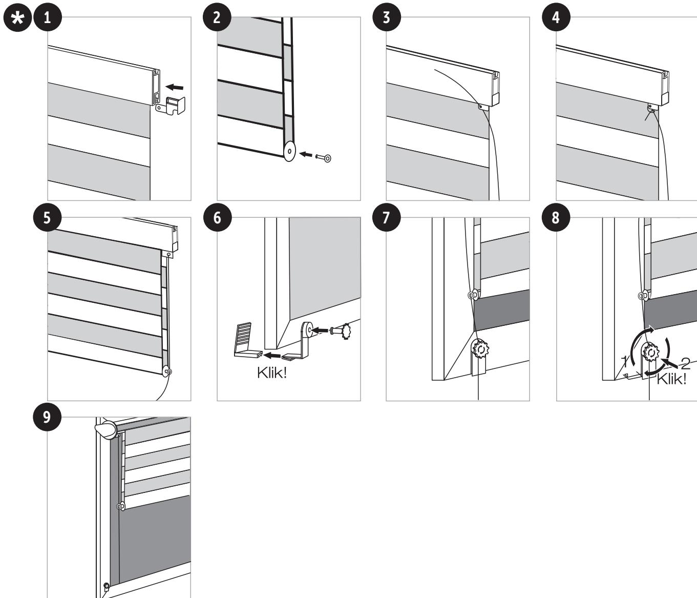
Changing the control side / Changement du côté de manoeuvre / Zmiana strony sterowania / Cambiar la posición del mecanismo
