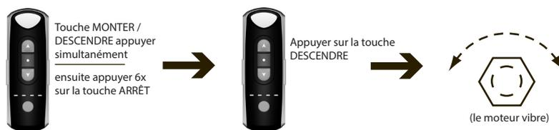
Maintenant, le moteur monte et descend tant que vous appuyez sur les touches MONTER et DESCENDRE. En mode manuel, appuyez sur la touche MONTER ou DESCENDRE pendant 3 secondes. Le moteur avance jusqu'au point final ou jusqu'à ce que vous appuyez sur la touche ARRÊT.
