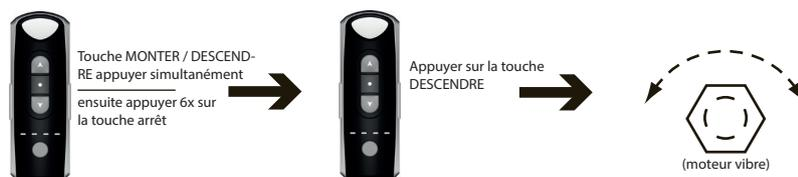
Maintenant, le moteur monte et descend seulement tant que vous appuyez sur les touches MONTER et DESCENDRE. En mode manuel, appuyez sur les touches MONTER ou DESCENDRE pendant 3 secondes, ainsi le moteur monte ou descend jusqu'au point final ou jusqu'à ce que vous appuyez sur la touche ARRÊT.
